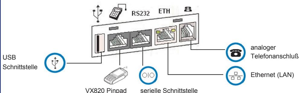
Das VX820 DUET bietet die Kommunikationsvarianten LAN, analog und über einen speziellen Dongle die Variante ISDN.
