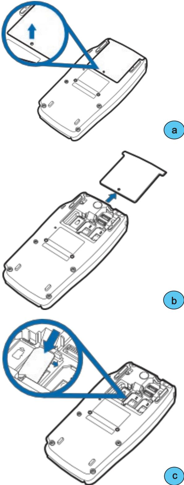
Für kontaktlose GeldKartenzahlungen („girogo“) wird die entsprechende Händlerkarte unter der Abdeckung an der Rückseite des Gerätes eingelegt.
