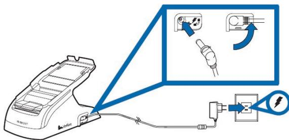
Zum Aus- und Wiedereinschalten des Gerätes trennen Sie bitte die Stromversorgung von der Basisstation (bei VX820 DUET) bzw. vom Multiportadapter (bei VX820 PIN Pad).
