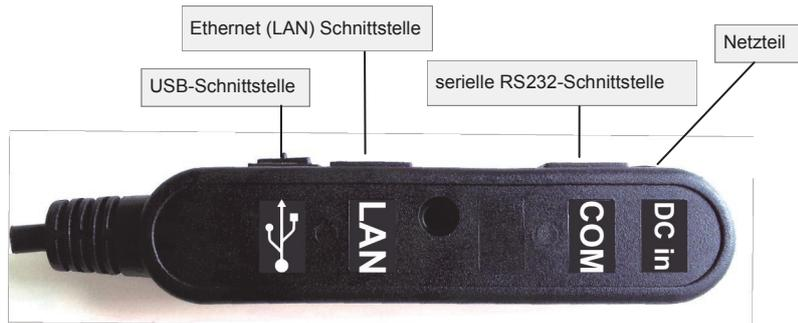
Das VX820 PP verfügt über einen Multiportadapter, an dem sämtliche notwendigen Anschlüsse für den Betrieb zur Verfügung gestellt werden.
