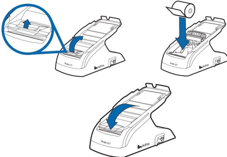
Zum Einlegen der Bonrolle bitte die Druckerklappe an der Rückseite des Gerätes öffnen, die Bonrolle einlegen und den Papieranfang über die Abrisskante ziehen.
