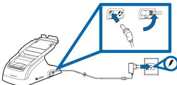
Zum Einschalten des Gerätes verbinden Sie bitte den beiliegenden Netzstecker mit dem Stromnetz.
