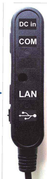
Den LAN Anschluss beim VX820 PIN Pad finden Sie am Multiportadapter. Der Anschluss ist mit „ETH“ (Ethernet) gekennzeichnet.
